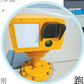
▲控制枢纽大厅,FOD探测管理平台实时显示机场跑道情况。 ▼机场跑道两侧的FOD探测器。
