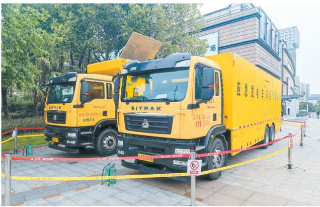
中压发电车临时供电实现检修不停电
