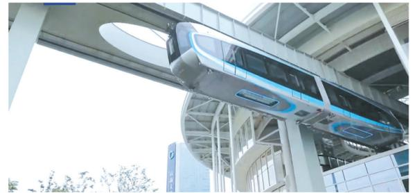
11日，国内首条悬挂式空中轨道列车光谷空轨试乘发车。空轨全称为“悬挂式轻型空中轨道”，其列车悬挂在单型轨道下方，将地面交通移至空中，属于立体交通，拥有独立路权，不受地面其他交通工具和行人干扰，是一种绿色低碳的城市轨道交通新制式。
