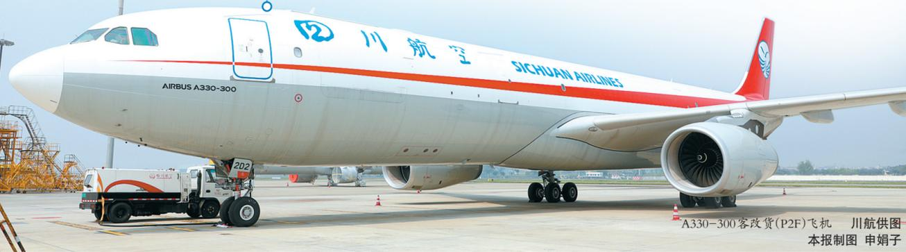
A330-300客改货(P2F)飞机 川航供图 本报制图 申娟子
