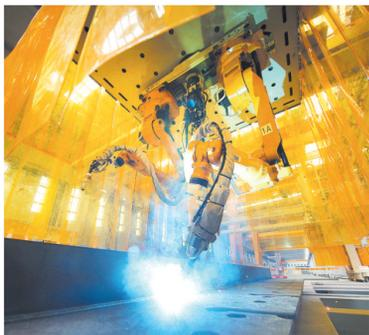
钢结构装配式生产基地自动化生产线
