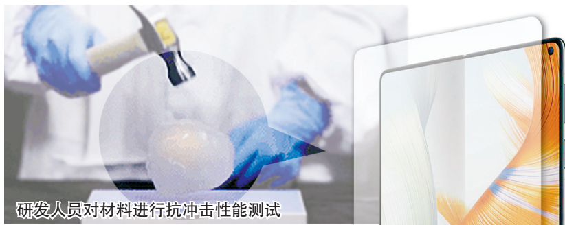
研发人员对材料进行抗冲击性能测试
