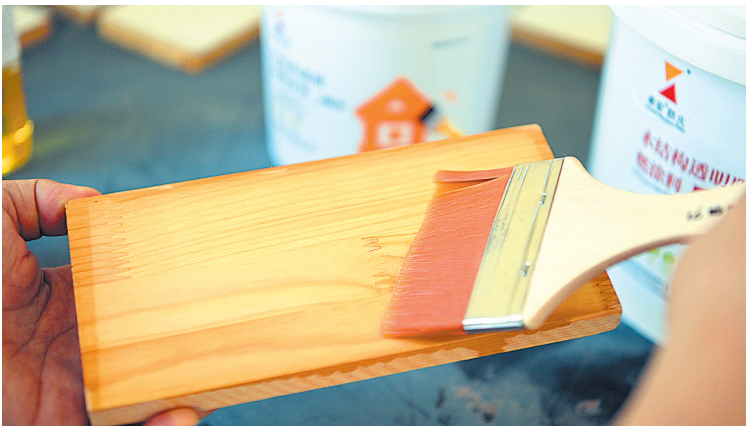
在木板表面涂刷阻燃涂料
