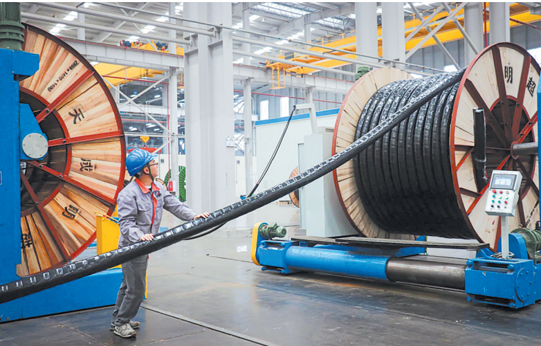
工人将成品线缆缠绕在轮盘上
