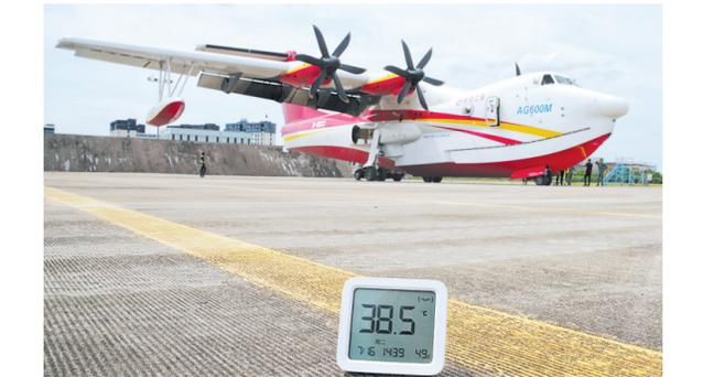
记者从中国航空工业集团了解到，7月16日，我国自主研发的大型水陆两栖飞机AG600完成了高温高湿飞行试验。此次试验在江西南昌进行，分为“暴晒飞机”及“测试系统”两个阶段。试验当天，AG600飞机首先在平均温度超过35℃、平均湿度超过44%的环境下暴晒超5小时，随后飞机按计划起飞，爬升到预定高度后持续完成一系列常规机动操作，飞行时长超2.5小时。
