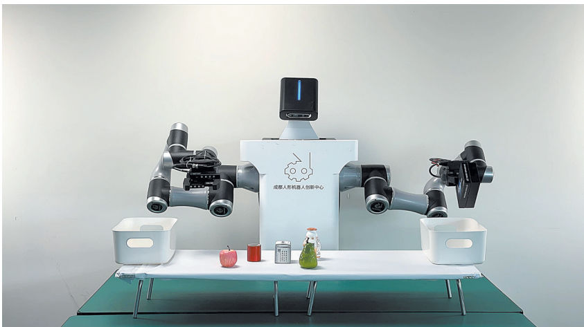
中国首个机器人多模态模型,可以相对明确地将水果和非水果进行区分和分拣
