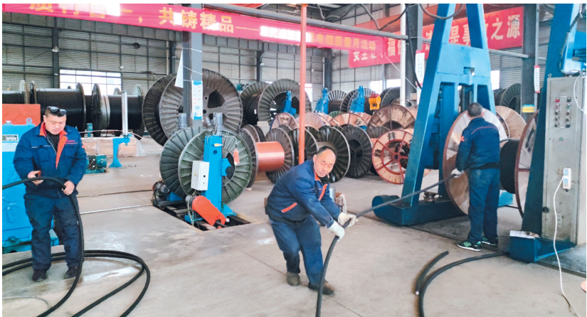
工人正协力把电缆绕在盘具上。
