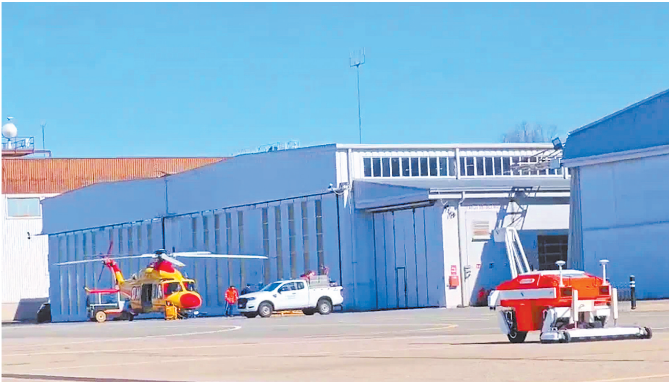
道面健康自动检测机器人在欧洲机场巡检。
